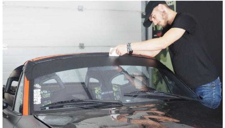
Drücken Sie den Blendstreifen oben genau an die Dichtung.
