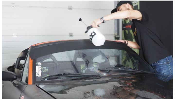
Besprühen Sie den oberen Teil des Streifens mit Wasser, damit bei den folgenden Schritten keine Kratzer entstehen.
