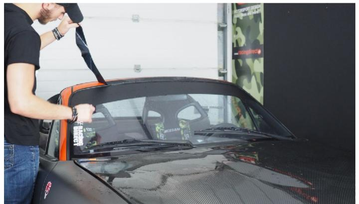
Entfernen Sie das überflüssige abgeschnittene Material.
