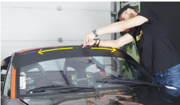
Schneiden Sie das Material an der Verbindungsstelle der Scheibe.
