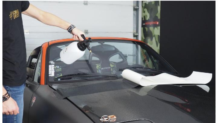
Entfernen Sie den halben Streifen des Trägerpapiers. Besprühen Sie die klebrige Seite gut mit Wasser. Verwenden ausschließlich sauberes Wasser **OHNE SEIFE UND DESINFIZIATIONSMITTEL.**
