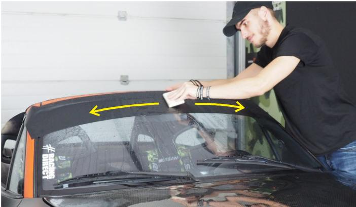
Entfernen Sie alle Luftbläschen und drücken Sie den Blendstreifen mit Hilfe der Rakeln auf die Scheibe, von der Mitte Richtung Rand.
